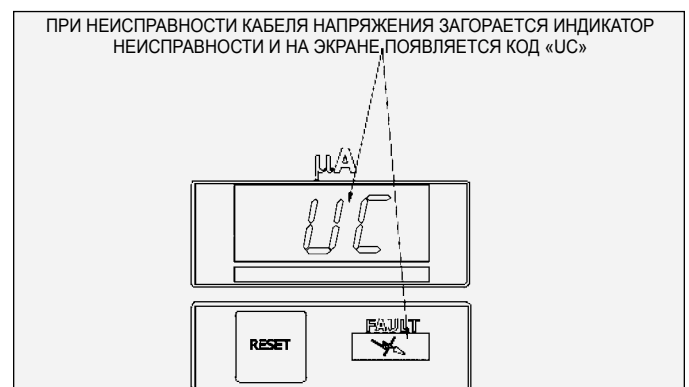
Рис. 27: Отображение неисправности кабеля напряжения
