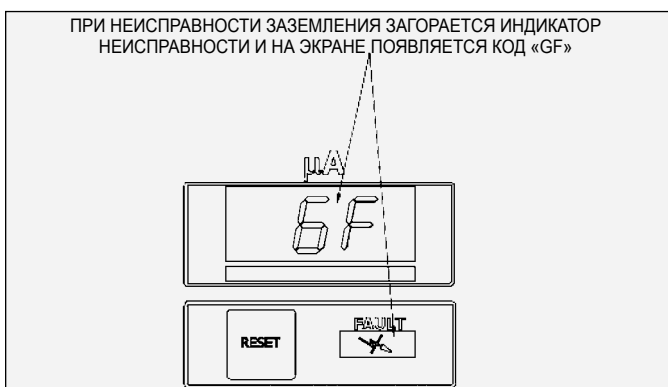
Рис. 24: Отображение неисправности заземления
